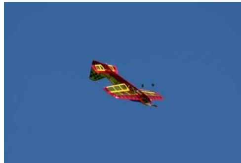
Mise en vrille plate sur le dos. Le moteur est coupé, la descente est lente.
