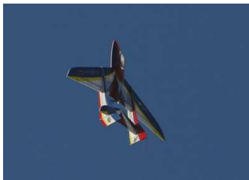
Le nez à la verticale, la dérive est bottée à fond juste avant la perte de vitesse pour que l'avion effectue son renversement.
