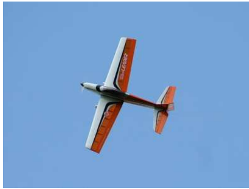
Vol tranche : C'est le fuselage qui porte. Il faut donc une action soutenue à la direction, qui fait office de profondeur dans cette configuration.
