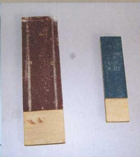
Exemples de cales à poncer « maison » qui permettent de poncer précisément les différentes surfaces du modèle.
