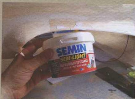
Cet enduit léger est particulièrement adapté à notre activité, on remarque en arrière plan le masticage en cour sur un fuselage.
